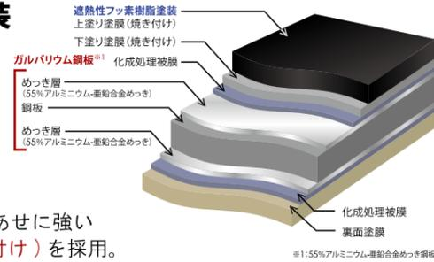
上塗り塗膜は遮熱性に加え色あせに強い遮熱性フッ素樹脂塗装(焼き付け)を採用。
