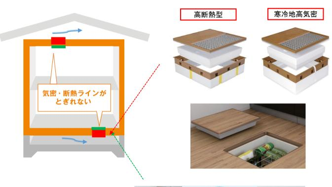
JISA4706(サッシ)の 気密性等級【A-4】に 相当、高い気密性能で 空気の出入りを阻止!
