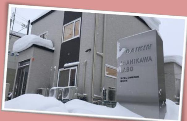
外気温 $-22.9^{\circ}\text{C}$ 時にエアコンの吹出温度  $44.3^{\circ}\text{C}$  を観測
