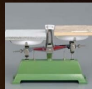
一般的な不燃壁材の 2/3の軽さ (ケイカル系化粧壁材との比較)
