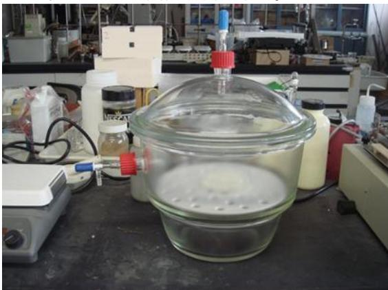
Phot.16 アンモニア吸着量測定用デシケーター
